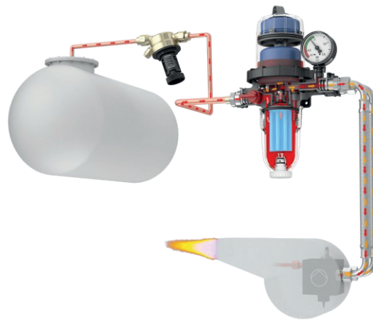
Abbildung 54: Filterprinzip für das Einstrangsystem mit Rücklaufzuführung am Beispiel Ölfiter-Entlüftungseinrichtung (Bildquelle: AFRISO)
