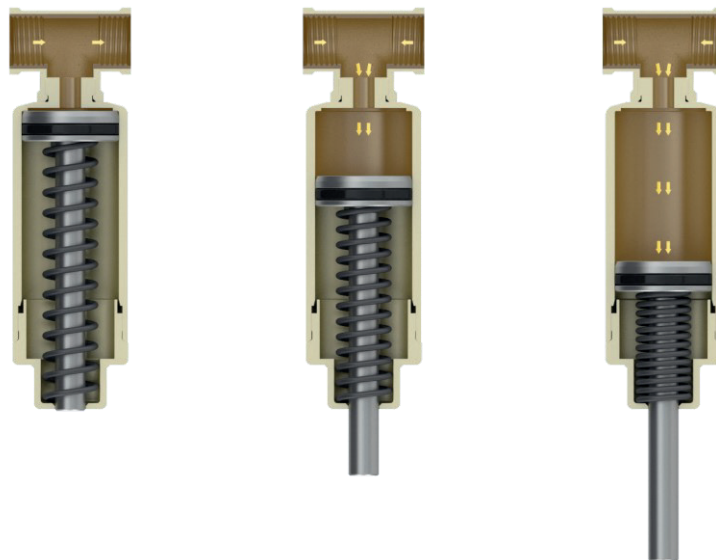
Abbildung 101: Funktionsprinzip einer Druckausgleichseinrichtung (Bildquelle: AFRISO)
