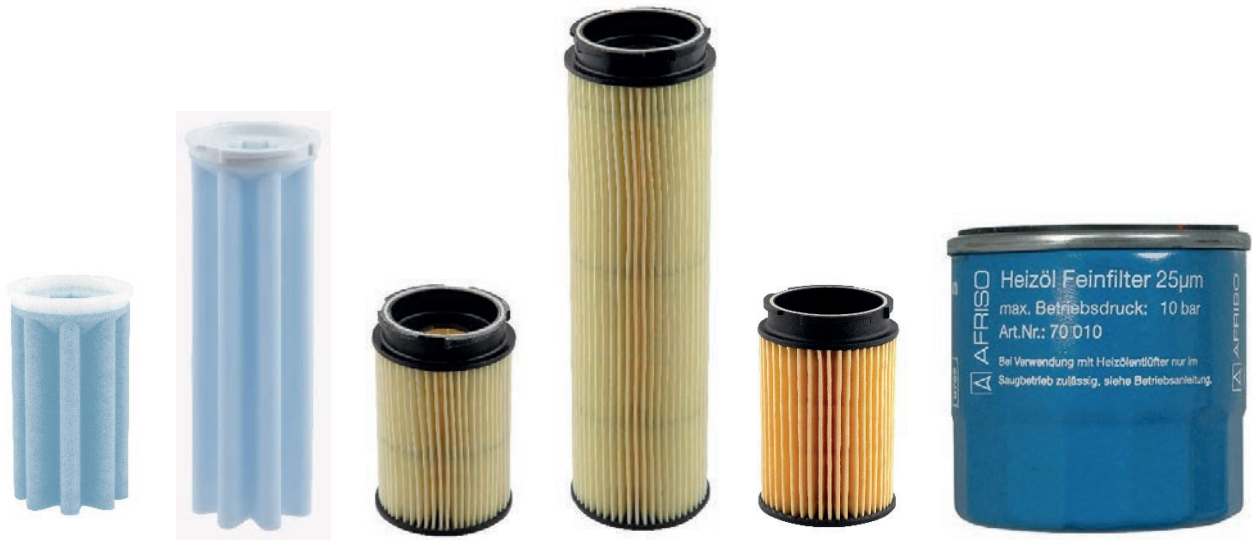
Abbildung 55: Gebräuchliche Filtereinsätze – von links nach rechts: Sinterkunststoff, Papier, Wechselfilter mit Metallgehäuse (Bildquelle: AFRISO)
