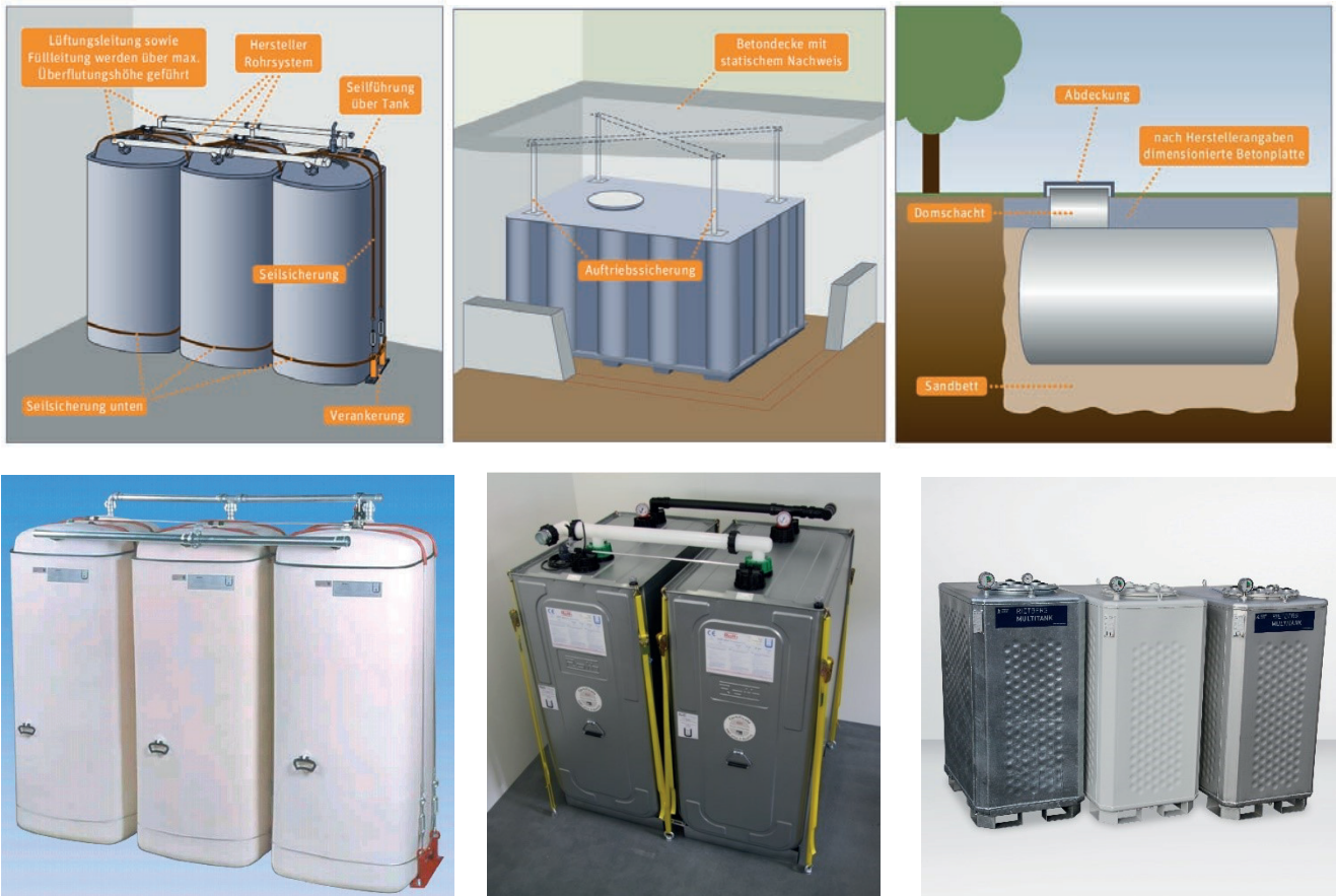
Abbildung 12: Aufstellungsbeispiele und hochwassersichere Öltanks aus Kunststoff und Stahl (Bildquelle: UNITI, Nau, ROTH, Seppeler)
