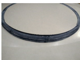
Abbildung 104: GFK-Öltank: Berstsicherung am Domdeckel in Form Gummilippe (Bildquelle: HAASE)
