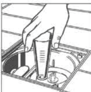
8. Rückstaeinheit mit Handverschluss schließen, Prüfvorrichtung einschrauben und diese mit Wasser füllen (100 mm).
