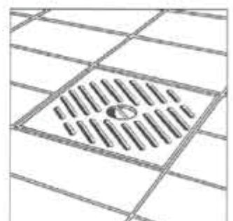
10. Geruchverschlüsse montieren und Rost einlegen.
