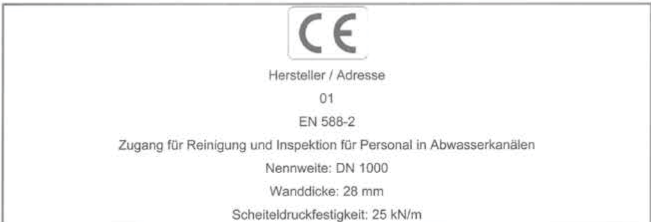
Bild 5 Beispiel einer CE-Kennzeichnung für Schächte aus Faserzement nach EN 588-2 auf Handelspapieren
