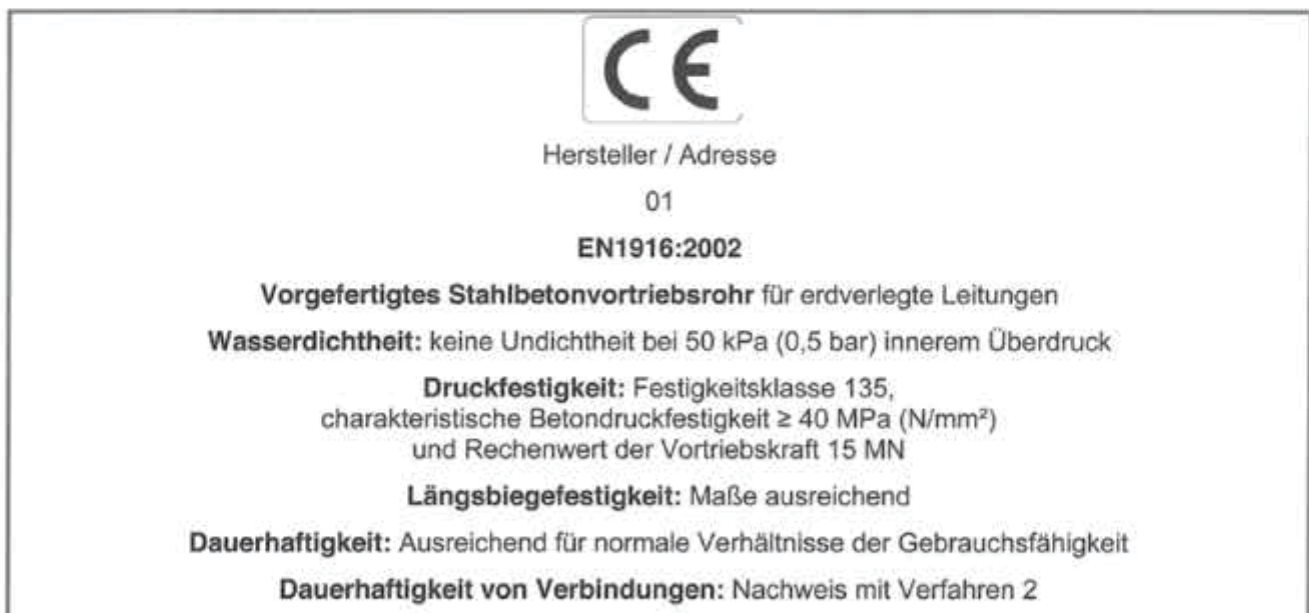
Bild 4 Beispiel einer CE-Kennzeichnung für Stahlbetonvortriebsrohre nach EN 1916
