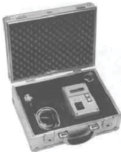
Bild 29 PC-unterstütztes Datenmess- und Speichergerät mit automatischer Auswertung nach DIN EN 1610 und ATV-DVWK-A 142 für mobile und stationäre Anwendung der Dichtheitsprüfung mit Luft oder Wasser. Werkbild: Härke GmbH & Co. KG
