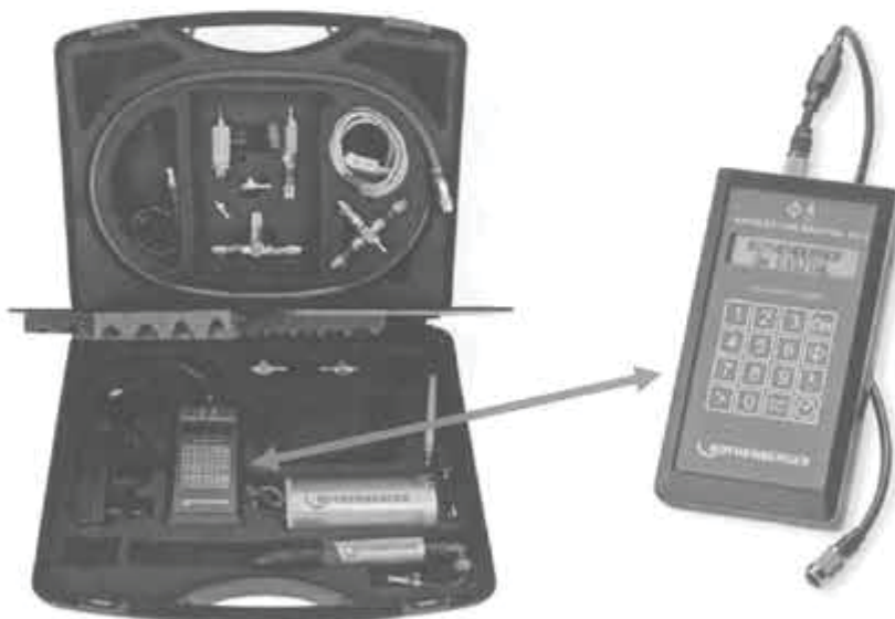
Bild 27 Universelles, digitales Dichtheitsprüfsystem für Gas-, Wasser- und Abwasserleitungen, Dichtheitsprüfung mit Luft und Wasser nach DIN EN 1610. Die Abbildung enthält nicht den Drucker (leeres Fach für Drucker). Werkbild: Rothenberger
