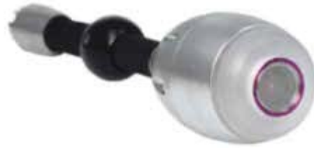
Bild 128 Axialkamera Farbkamera K-50 Fa. Kummert mit automatischem Horizontalausgleich und aufrechtem Bild. Einsatz ab einem Durchmesser von DN 70 und 88° und voll bogengängig. Ihr kantenloser Kopf aus Edelstahl und der flexible Gewebes Schlauch ermöglichen ein problemloses Gleiten durchs Rohr und verhindern ein Verhaken beim Zurückziehen der Kanalkamera. Werkbild: Fa. Kummert
