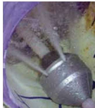
Bild 119 IBAK PHOBOS 1 als Spüleinheit mit Düsendurchsatz von 45 l/min und IBAK ORION L .
