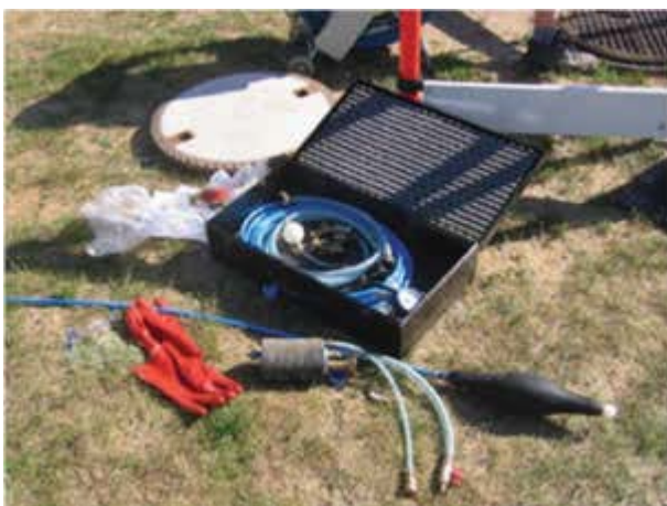
Bild 133 Absperrblasen für die Dichtheitsprüfung Foto: Stadtentwässerung Braunschweig GmbH
