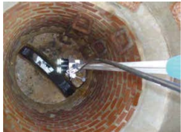
Bild 34 Schachtinspektionskamera/ Elektronischer Kanalspiegel STV-2 Werkbild: Fa. Messen Nord GmbH
