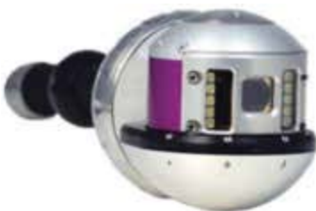
Bild 127 Schwenkkopfkamera K-70 der Fa. Kummert. Die Dreh- und Schwenkkopfkamera K-70 ist ab einem Durchmesser von DN100 und 88° voll bogengängig. Der Schwenkbereich +/-115°, endlos Drehbereich, motorischen Fokus, und automatischer Horizontalausgleich. Werkbild: Fa. Kummert
