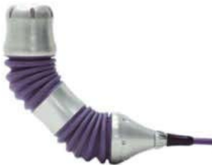
Bild 126 Abbiegefähige Inspektionskamera CamFlex® der Fa. Kummert Die Kamera kann problemlos verzweigte Grundleitungen ab DN 100 bis 200 befahren und in Abzweige vordringen. Als Besonderheit der speziell für die Inspektion der GEA entwickelten, wurmförmlichen Kamera, ist deren Verformbarkeit zu nennen. Dies bedeutet, die Kamera selbst kann sich von gerader Lage auf 90° verformen, wodurch nahezu alle Seiteneinläufe erreicht und auch 90° Bögen durchfahren werden können. Werkbild: Fa. Kummert, www.kummert.de
