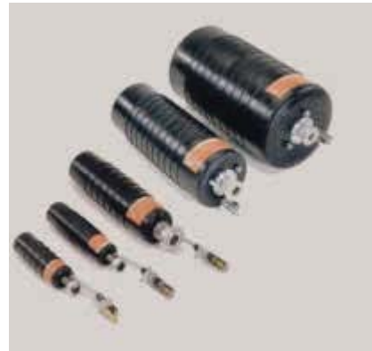
Bild 134 MU-Absperrprüfblasen ab DN 80 mit Durchgang, zur Absperrung von Entwässerungskanälen bis DN 1000 oder zur Dichtheitsprüfung nach DIN EN 1610.
