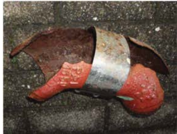
Bild 205 Fehlende Wand (oben), Korrosion durch BSK, BAF I D, Schadensklasse A
