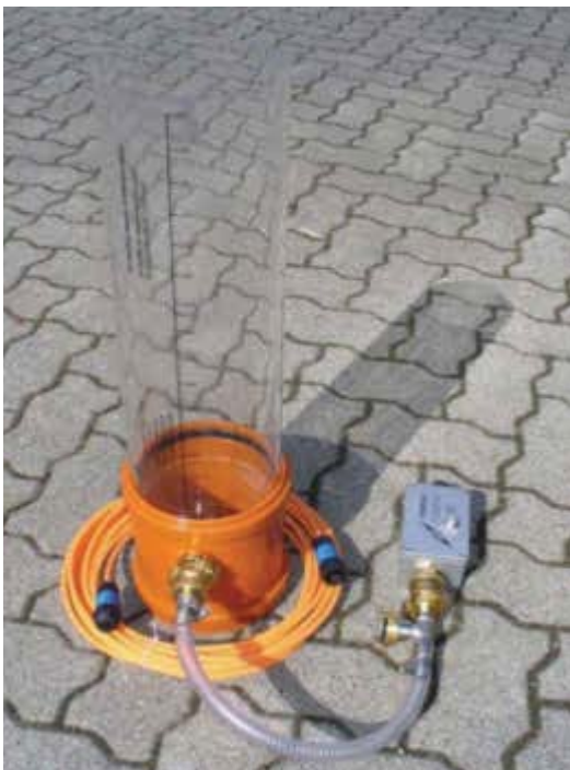
Bild 140 MPG Grundgerät mit integrierter Befüllarmatur Rechts im Bild: Externer Präzisions-Wasserdrucksensor, angeschlossen am Absperrorgan im Schacht (Bild 142) Werkbild: Fa. Messen Nord GmbH, www.messen-nord.de
