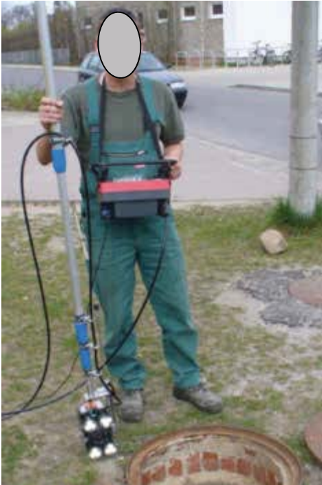
Bild 24 Schachtinspektionskamera/Elektronischer Kanalspiegel STV-2 Werkbild: Fa. Messen Nord GmbH
