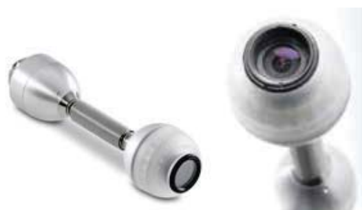
Bild 115 IBAK HYDRUS (Aktualsichtkamera) für Leitungen ab DN 50 Diese Kamera ist eine kleine bogengängige Inspektionskamera für den Schiebetrieb. Zur Inspektion von Leitungen geringer Nennweiten ab DN 50 innerhalb eines Gebäudes einsetzbar. Dank ihrer Flexibilität lässt sich die HYDRUS problemlos durch mehrere Bögen hintereinander schieben; die integrierte und regelbare LED-Beleuchtung leuchtet den Untersuchungsbereich optimal aus. Werkbild: Fa. IBAK Helmut Hunger GmbH & Co.KG
