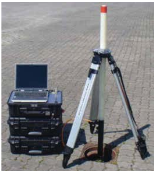
Bild 47 System ROHRTEST-4, Schacht- und Abscheiderprüfgerät RT-SP04 Werksbild MESSEN NORD GmbH www.messen-nord.de
