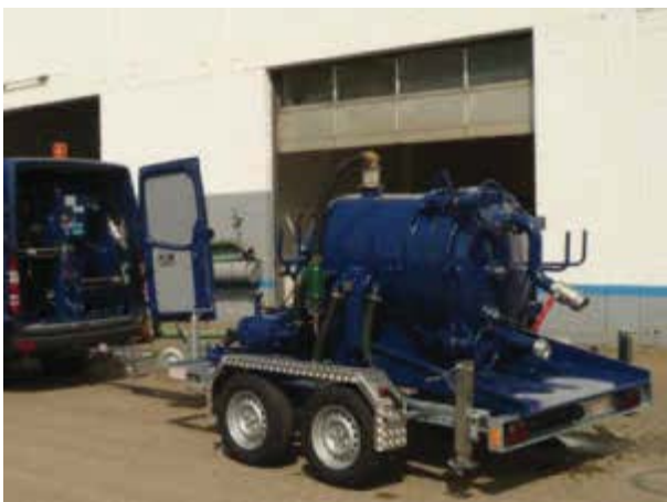
Bild 106 Spülfahrzeug mit Sauganhänger MU-Vacumaster A 10 (Anhänger) Behältervolumen: 1000 l Pumpenleistung: 290 m 3 /h Werkbild: MÜLLER Umwelttechnik GmbH & Co. KG
