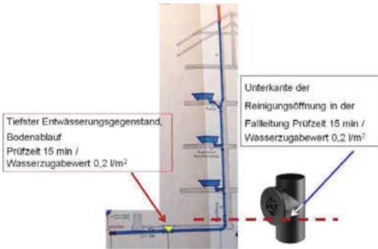
Bild 37 Erläuterung der vereinfachten Dichtheitsprüfung DR 2
