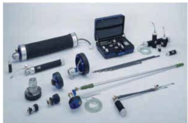
Bild 135 Geräte zur Absperr- und Prüftechnik zur Dichtheitsprüfung.
