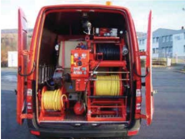
Bild 105 Spülwagen MU-Pipemaster E10, Rohrleitungsreinigung mit Hochdruck (HD) bis DN 150, Behältervolumen 1000 l, Volumenstrom 100 l/min, Pumpendruck 150 bar (Druck ist veränderbar) Werkbild: MÜLLER Umwelttechnik GmbH & Co. KG www.mueller-umwelt.de
