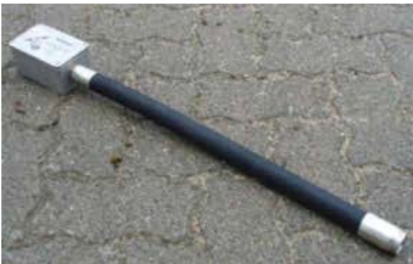
Bild 143 Rüsselsensor RT-SP04: Pegelsensor für die Dichtheitsprüfung als alternative kostengünstigere Gerätschaft zur Pegelmessung mittels Lasermessung (Bild 47) wie bei Abscheideranlagen für Leichtflüssigkeiten und Fette. Werkbild: Fa. Messen Nord GmbH
