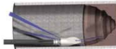
Bild 107 Spitzdüse im Rohr zur Lockerung verfestigter Ablagerungen Werkbild: Fa. Enz
