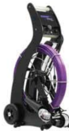
Bild 129 CamMobile Compact mit Haspel und Monitor Die Auswahl an Kameraköpfen reicht von Axialkameras ab DN 50 (K-35) über Axialkameras mit ständig aufrechtem Bild ab DN 70, bis hin zu Dreh- und Schwenkkopf-kameras ab DN100. Werkbild: Fa. Kummert
