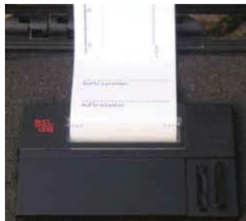
Bild 142 MPG Grundgerät mit integrierter Befüllarmatur und optionalem Protokolldrucker. Werkbild: Fa. Messen Nord GmbH
