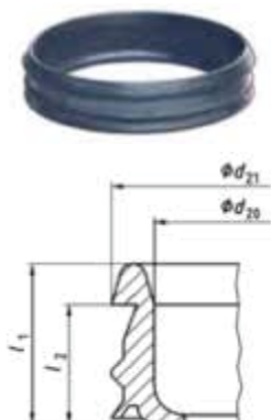
Bild 190 Steckmuffendichtring, Querschnitt aus DIN EN 1123-2
