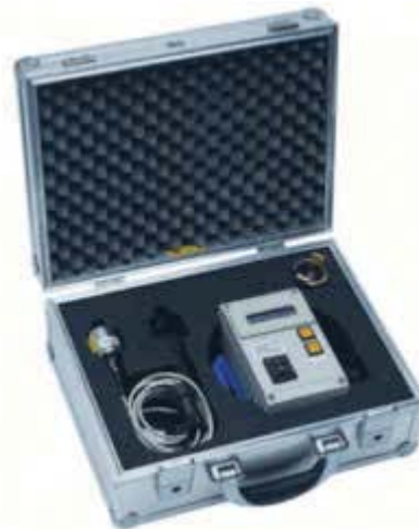
Bild 145 Messkoffer zur Messdatenerfassung und Auswertung von Dichtheitsprüfungen nach DIN EN 1610 bzw. DIN 1986-30 Die Geometrie des zu prüfenden Schachtes oder der Abwassersammelgrube ist vor der Prüfung über die Software per Laptop in das Messgerät einzugeben. Während der Prüfung erfolgt, ähnlich wie bei der im Bild 142 genannten Prüfung, keine Wasserzugabe. Der Wasserverlust wird über den Druckverlust ermittelt. Werkbild: Härke GmbH & Co. KG
