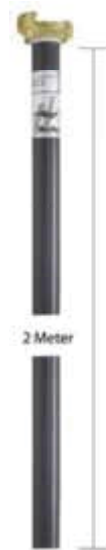
Bild 144 Tauch-Messrohr mit Geka-Kupplung für die Schachtprüfung, nicht für die Dichtheitsprüfung von Abscheideranlagen für Leichtflüssigkeiten und Fette. Das Messrohr sollte ca. 1 m in den mit Wasser gefüllten Schacht oder die Abwassersammelgrube im rechten Winkel zur Wasseroberfläche einzutauchen. Bei Schachtprüfungen mit einer Füllhöhe von 0,50 m über Rohrsohle sollte diese Füllhöhe für die Eintauchtiefe genutzt werden. Vor dem Eintauchen ist die Messsonde (links im Messkoffer Bild 145) über den Adapter (rechts oben im Messkoffer) an das Messrohr anzuschließen. In dem Rohr befindet sich jetzt im wasserlosen Teil komprimierte Luft. Werkbild: Härke GmbH & Co. KG
