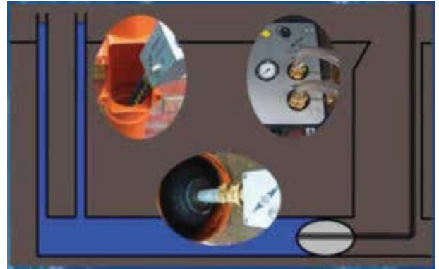
Bild 141 MPG, Prinzipskizze Grundgeräteeinsatz und Anschluss der Messeinrichtung (siehe Bilder 140–143) Werkbild: Fa. Messen Nord GmbH
