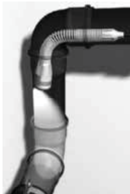
Bild 27 Kamerasonde „Tiny“ Hier Prüfung einer Sammelleitung innerhalb des Gebäudes Werkbild: RICO, Gesellschaft für Mikroelektronik GmbH
