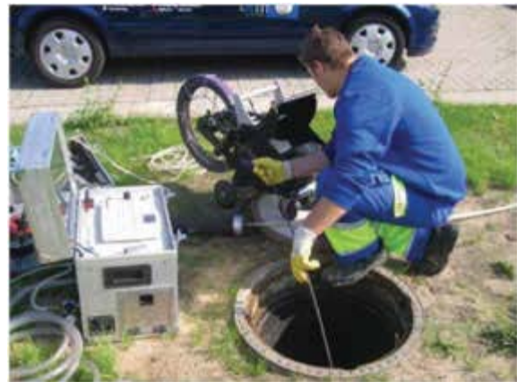
Bild 113 Einschieben der Kamera und Beobachtung auf dem mobilen Monitor Foto: Stadtentwässerung Braunschweig GmbH
