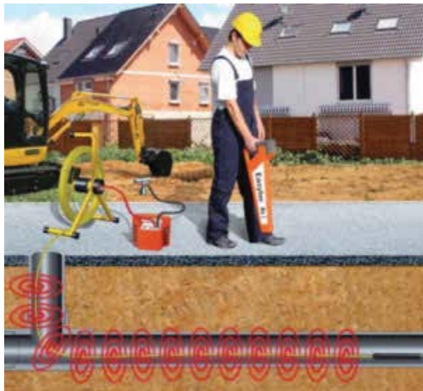
Bild 160 GOK 50-R Glasfaserortungskabel mit Molch zur Ortung von nicht-metallischen Rohren.
